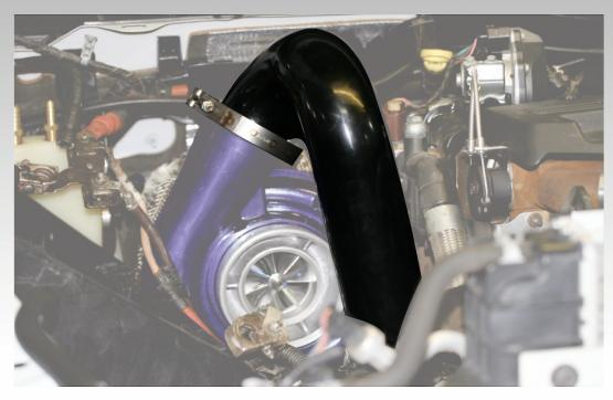
36.) USING VISE GRIPS, CLAMP THE V-BAND CLAMP (PN 24 FIG.1) AROUND THE CHARGE PIPE AND COMP HOUSING.
