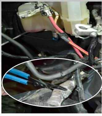
9.)DISCONNECT HOSE GOING TO EGR COOLER ON THE ENGINE SIDE. DISCONNECT THE HOSE GOING TO THE RADIATOR AT TANK SIDE.
